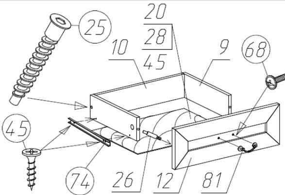
Установка шариковых направляющих (поз.74)
